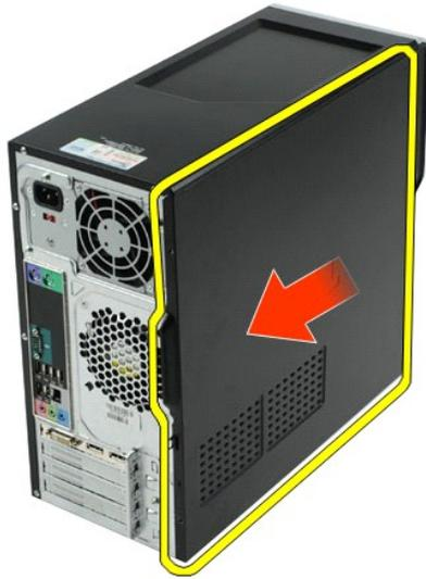
4. Levante y extraiga la cubierta del equipo.
