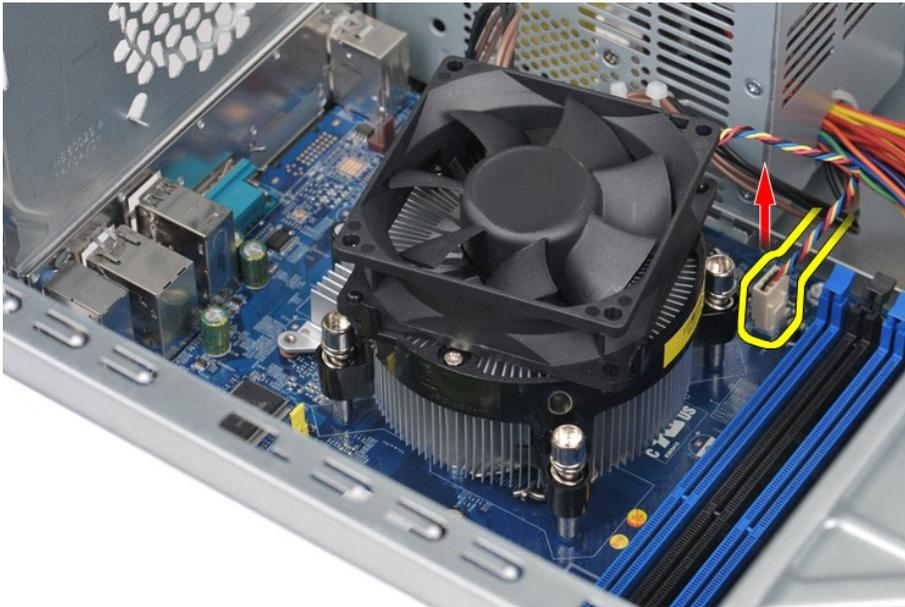
4. Utilice un destornillador de estrella para aflojar los cuatro tornillos de sujeción que fijan el conjunto del disipador de calor y ventilador a la placa base.
