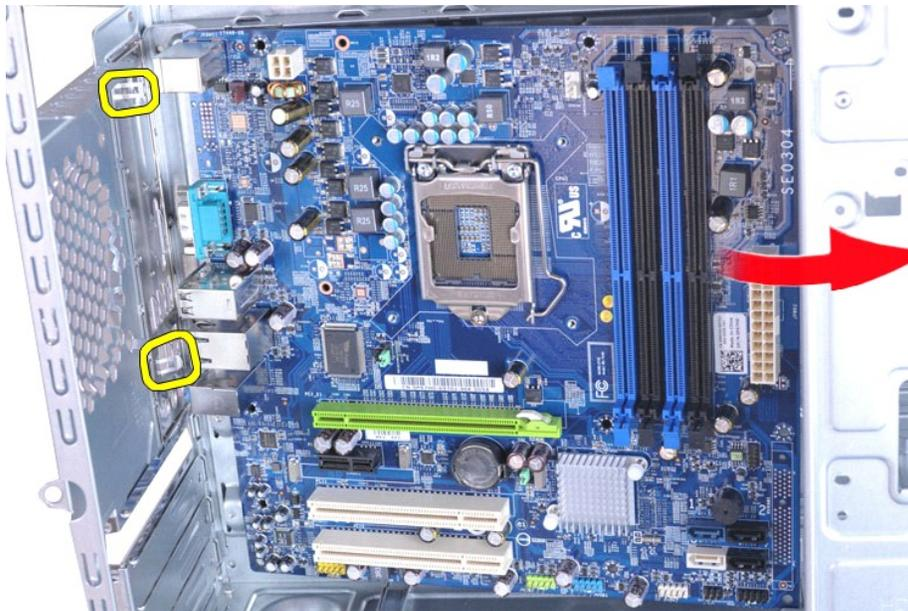
**⚠ AVISO:** cuando vuelva a colocar la placa base, deslízela bajo las lengüetas metálicas. Si presiona la placa base (cuando está colocada sobre las lengüetas metálicas) puede dañar la placa base.
