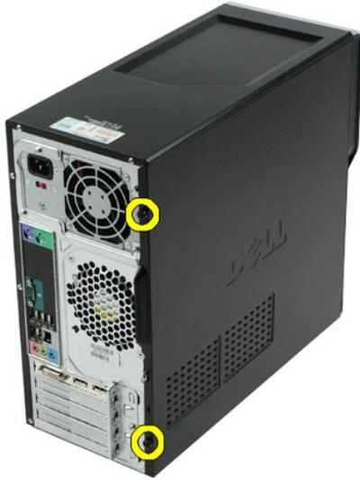
3. Saque la cubierta deslizándola hacia la parte posterior del equipo.
