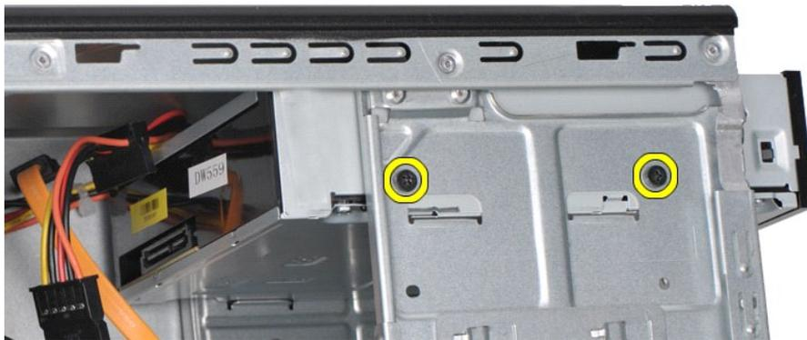
7. Deslice la unidad óptica hacia fuera por la parte frontal del equipo.
