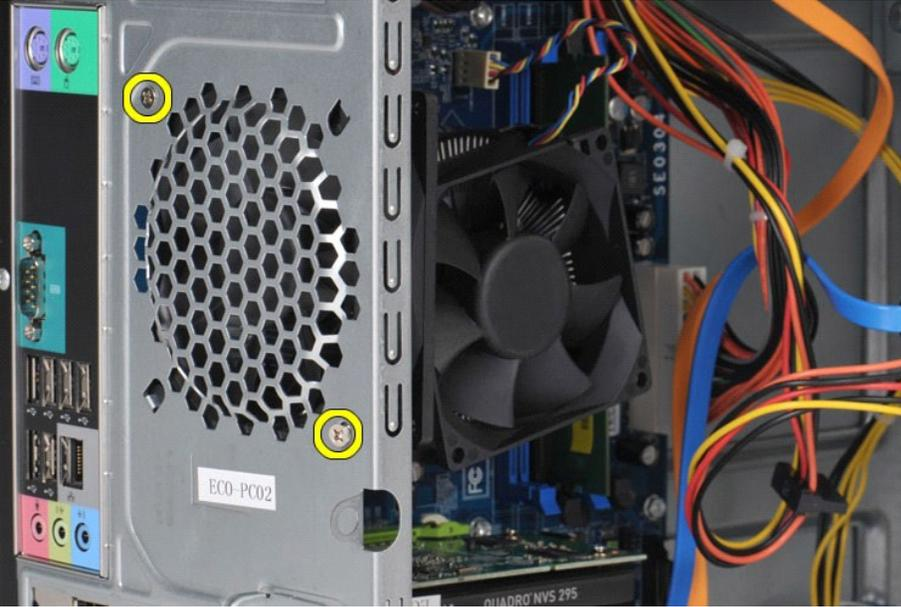
5. Desplace el ventilador hacia el centro del equipo y levante el ventilador para sacarlo del chasis.
